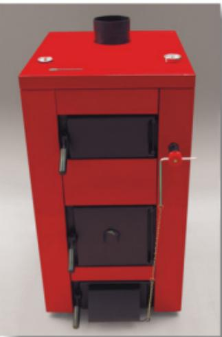
Cazan cu focar tip cameră de apă, cu focar și două circuite convective de gaze de ardere; sunt destinate pentru încălzirea clădirilor și producerea apei calde utilizând în procesul de ardere combustibil solid (lemn, deșeuri de lemn, cărbune, cocs, brișete rumegeu); sunt echipate cu două schimbătoare de căldură: serpentini pentru producerea apei calde menajere și serpentini de răcire - protecție suprareîncălzire cauzată.
